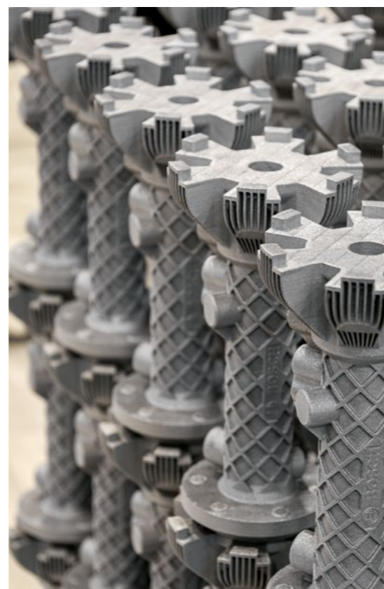
Wasserstoff-Kompressor aus einer Kooperation von Bosch und Nikon. Das Bauteil aus AlSi10Mg entstand in 48 Stunden in einer NXG XII 600 und vereint Leichtbau mit verschiedenen integrierten Funktionen, die die Leistung insgesamt verbessern sollen.
