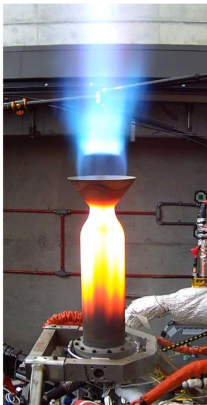
Für die M-1-Mission zum Mond wurde dieses Bauteil einer Raketendüse von Intuitive Machines gedruckt.
