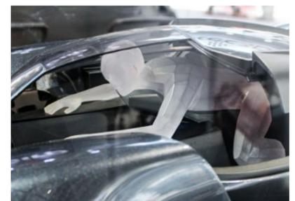
Beispiel aus dem Bereich Prototyping und Produktentwicklung von Cirp: Instrumentenblende und Träger (oben), Blaulicht-Kleinserie für Krankenkassenwagen (mitte), ein mit Stereolithographie gefertigtes und veredeltes Designmodell eines Elektrofahrzeugs (unten).
