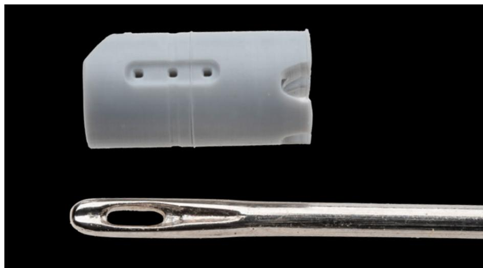
verwendet ein fotoreaktives Harz, angereichert mit feinem Metallpulver. Eine Lichtquelle härtet das Harz selektiv Schicht für Schicht aus, sodass ein »grünes Teil« entsteht. Anschließend erfolgt das thermische Entbindern und Sintern, bei dem das Bindemittel entfernt und die Metallpartikel zu einem dichten, vollmetallischen Bauteil verschmolzen werden. Incus3D verwendet diese Technologie.
