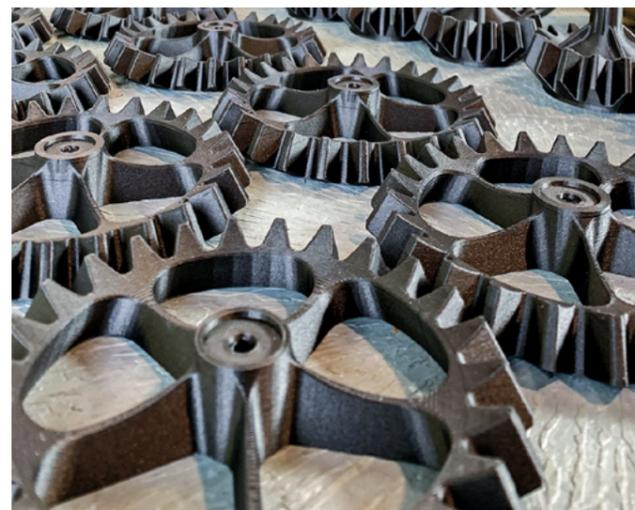
3D-gedruckte Ersatzteile für den Twister von BMF
