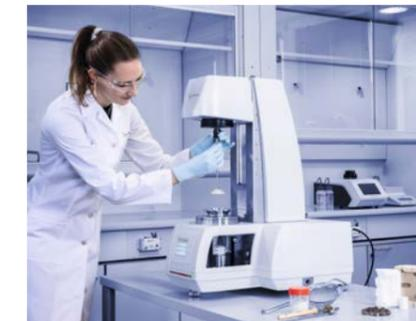
für Pharmakunden ist damit gegeben. Die automatische Erkennung der Messgeometrie und die automatische Anpassung der Einstellung in der RheoCompass-Software über den Toolmaster spart Zeit und eliminiert Fehler, die bei der manuellen Änderung der Einstellungen auftreten können. Zusammen mit den Gaspyknometern der Ultrapyc-Serie von Anton Paar liefern die MCR-Rheometer mit dem Hüllendichte-Set nun die nötigen Dichtewerte zur Bestimmung der Porosität von Proben.
