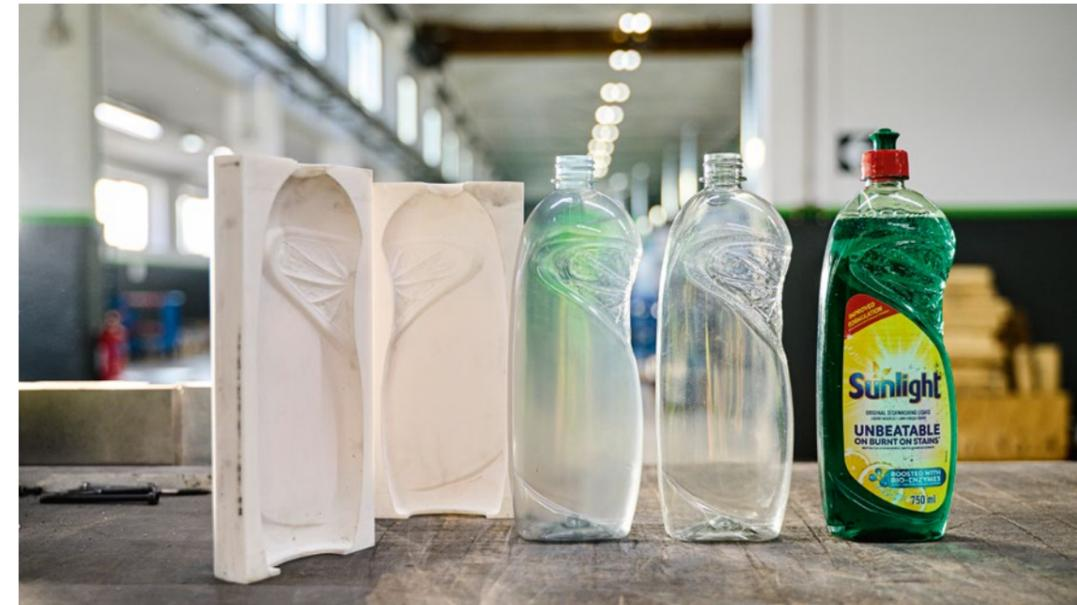
Foto links: Von der zweiteiligen 3D-gedruckten Form und der damit produzierten Flasche über eine mit einer Stahlform produzierten Flasche bis zum etikettierten Prototyp für Verbrauchertests
