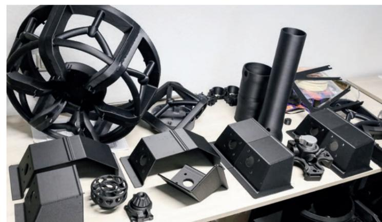
Unterschiedliche Bauteile, die in der Tec-Farm produziert wurden. Links oben die Halterung für den Hauptmotorgeber
