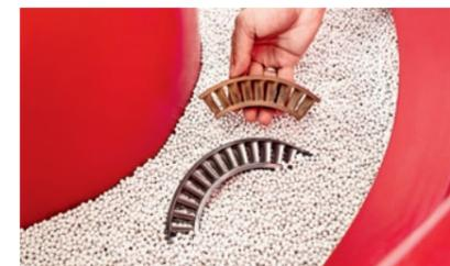
Relativbewegung zwischen Bauteil und Schleifkörpern, die eine glatte, homogene Oberfläche erzeugt. Christoph Cruse, Vertriebsdirektor bei Walther Trowal, sieht den TRT 83/87 als Einsteigermodell für AM-Anwender.
