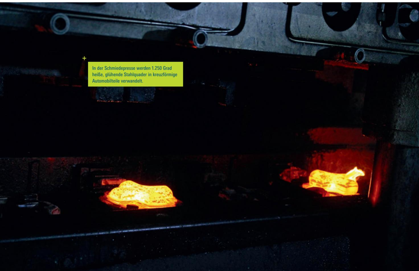
In der Schmiedepresse werden 1.250 Grad heiße, glühende Stahlquader in kreuzförmige Automobilteile verwandelt.
