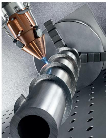
Trumpf hat sich auf zwei AM-Technologien festgelegt: Laser Metal Deposition (LMD) und Technologien Laser Metal Fusion (LMF).
