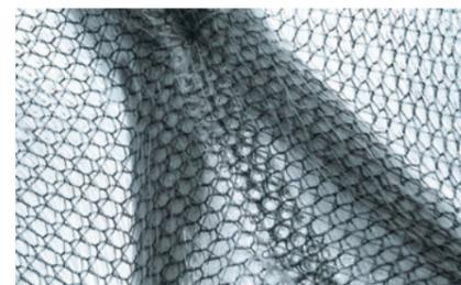
fliegen können. Markant ist seine feine und elastische Flughaut, die sich auch in seiner bionischen Variante wiederfindet: Hier besteht sie aus zwei luftdichten Folien und einem Elastan-Gestrick. Beide Komponenten sind an rund 45.000 Punkten miteinander verschweißt.
