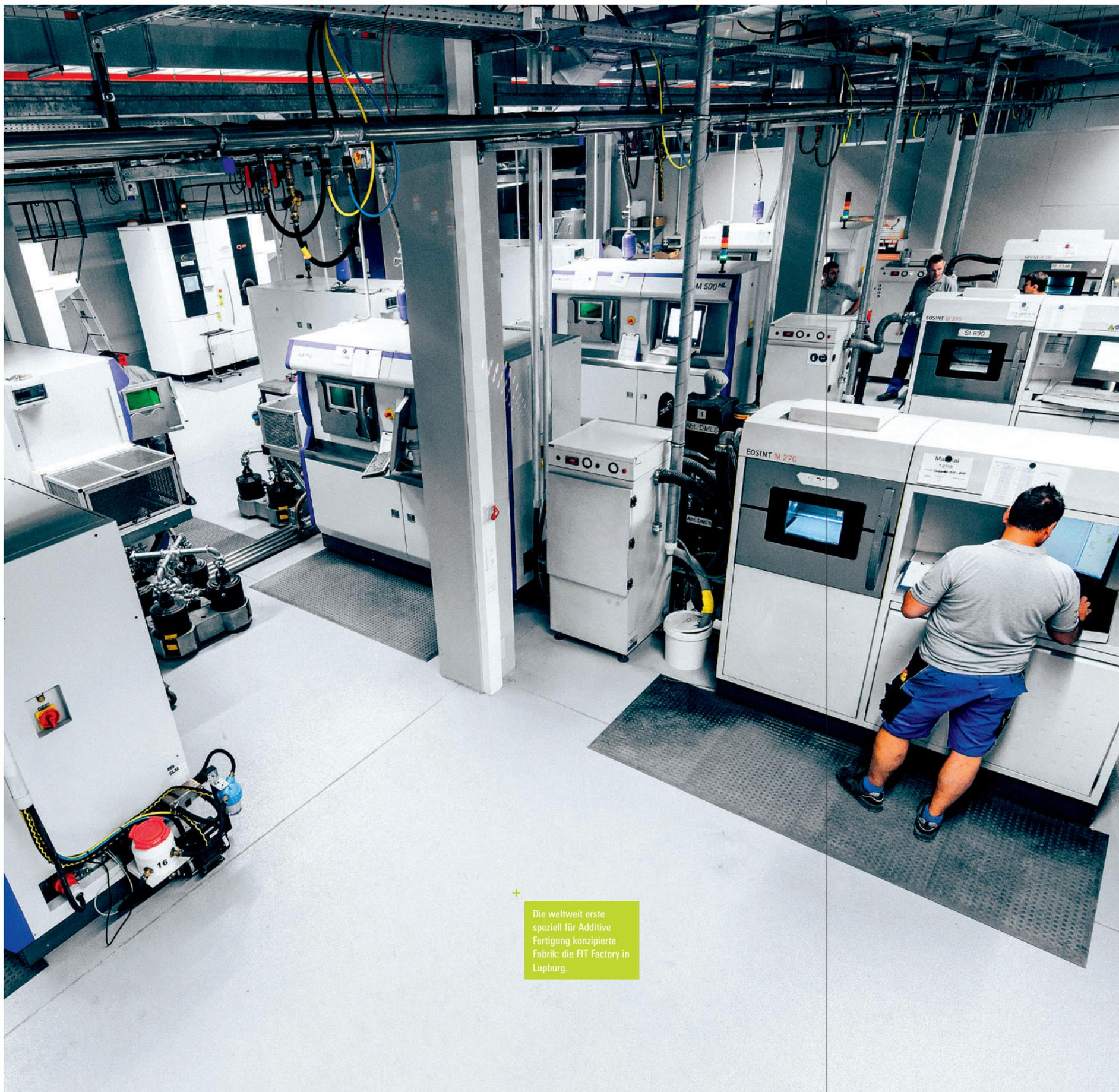
+ Die weltweit erste speziell für Additive Fertigung konzipierte Fabrik: die FIT Factory in Lupburg.
