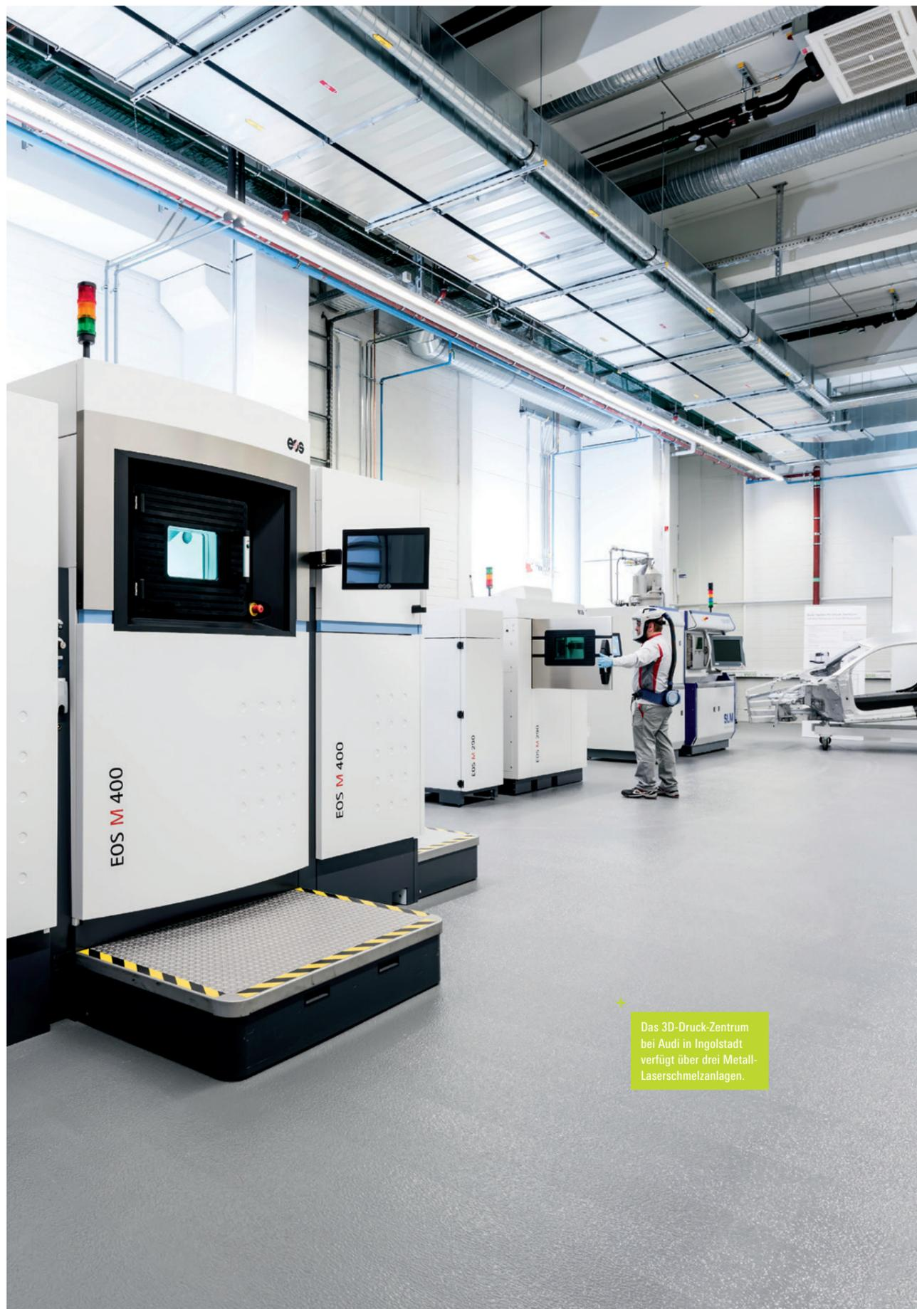
Das 3D-Druck-Zentrum bei Audi in Ingolstadt verfügt über drei Metall-Laserschmelzanlagen.
