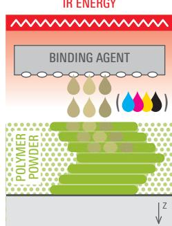
Minuscole goccioline di liquido vengono distribuite localmente su uno strato di polvere polimerica. Esse potenzianno o inibiscono l'assorbimento di calore da parte del materiale. Una fonte di infrarossi a riscaldamento integrale fonde localmente il materiale granulare di partenza.
